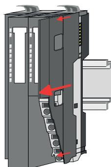
1. Entfernen Sie vor der Montage der Peripherie-Module die Bus-Blende auf der rechten Seite des Bus-Kopplers, indem Sie diese nach vorn abziehen. Bewahren Sie die Blende für spätere Montage auf.
