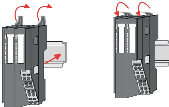
2. Klappen Sie die Verriegelungshebel des Bus-Kopplers nach oben, stecken Sie den Bus-Koppler auf die Tragschiene und klappen Sie die Verriegelungshebel wieder nach unten.
