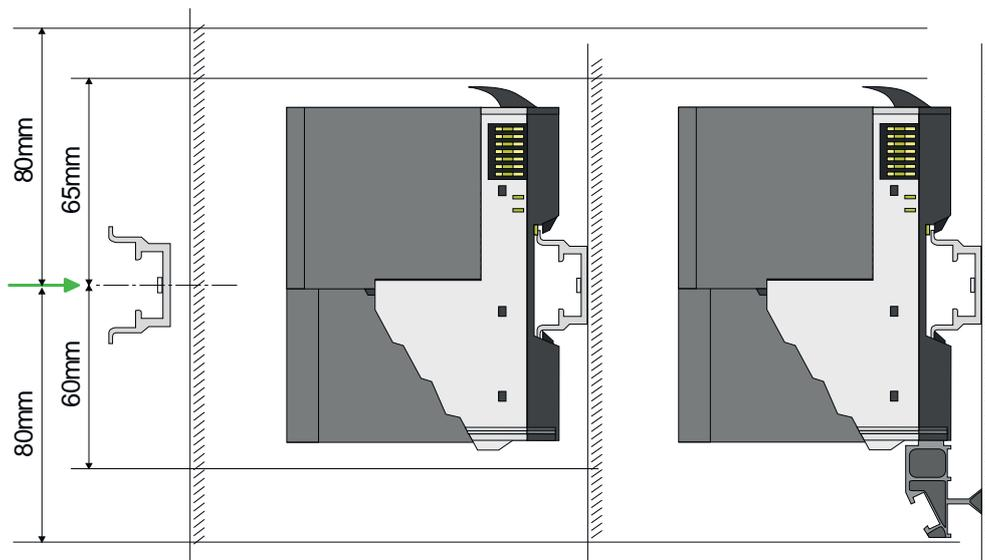
1. Montieren Sie die Tragschiene! Bitte beachten Sie, dass Sie von der Mitte der Tragschiene nach oben einen Montageabstand von mindestens 80mm und nach unten von 60mm bzw. 80mm bei Verwendung von Schirmschienen-Trägern einhalten.
