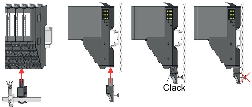
3. Legen Sie ihre Kabel mit dem entsprechend abisolierten Kabelschirm auf und verbinden Sie diese über die Schirmanschlussklemme mit der Schirmschiene.
