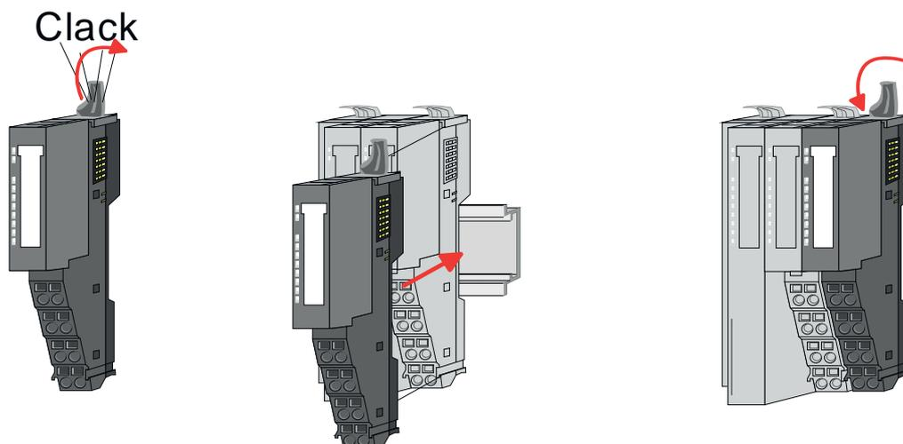
2. → Montieren Sie die gewünschten Peripherie-Module.
